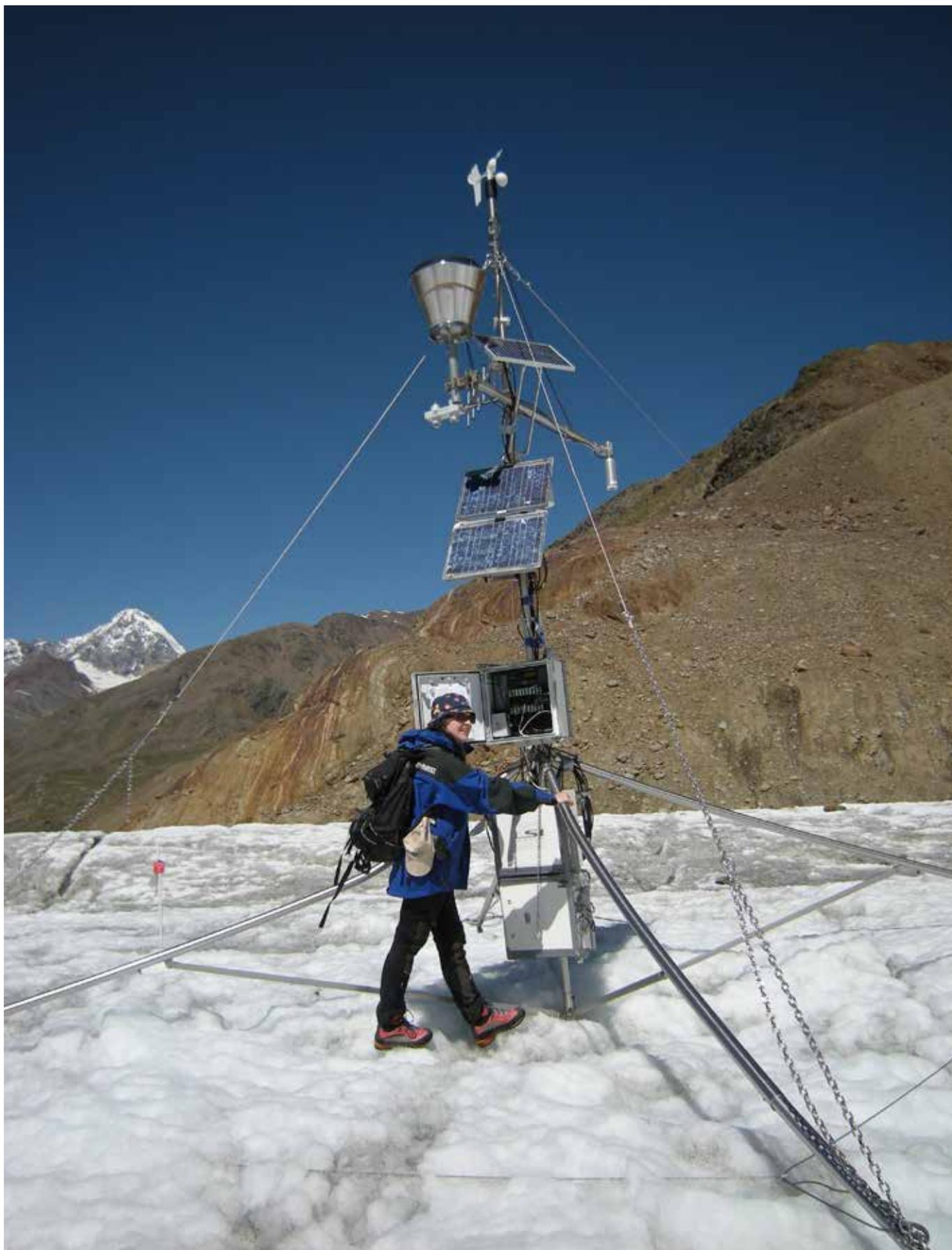
*FORNI: La Stazione Meteorologica Automatica (AWS-Automatic Weather Station) collocata nel 2005 sulla lingua del Ghiacciaio dei Forni a 2700 m a cura dell'Università degli Studi di Milano, prima stazione italiana su ghiacciaio. Inserita in reti di misura internazionali, i suoi dati permettono studi approfonditi, ad esempio sull'evoluzione dell'albedo, anche in funzione della copertura detritica, e sul bilancio energetico del ghiacciaio con i suoi effetti sul bilancio di massa (ph. C. Smiraglia)*
