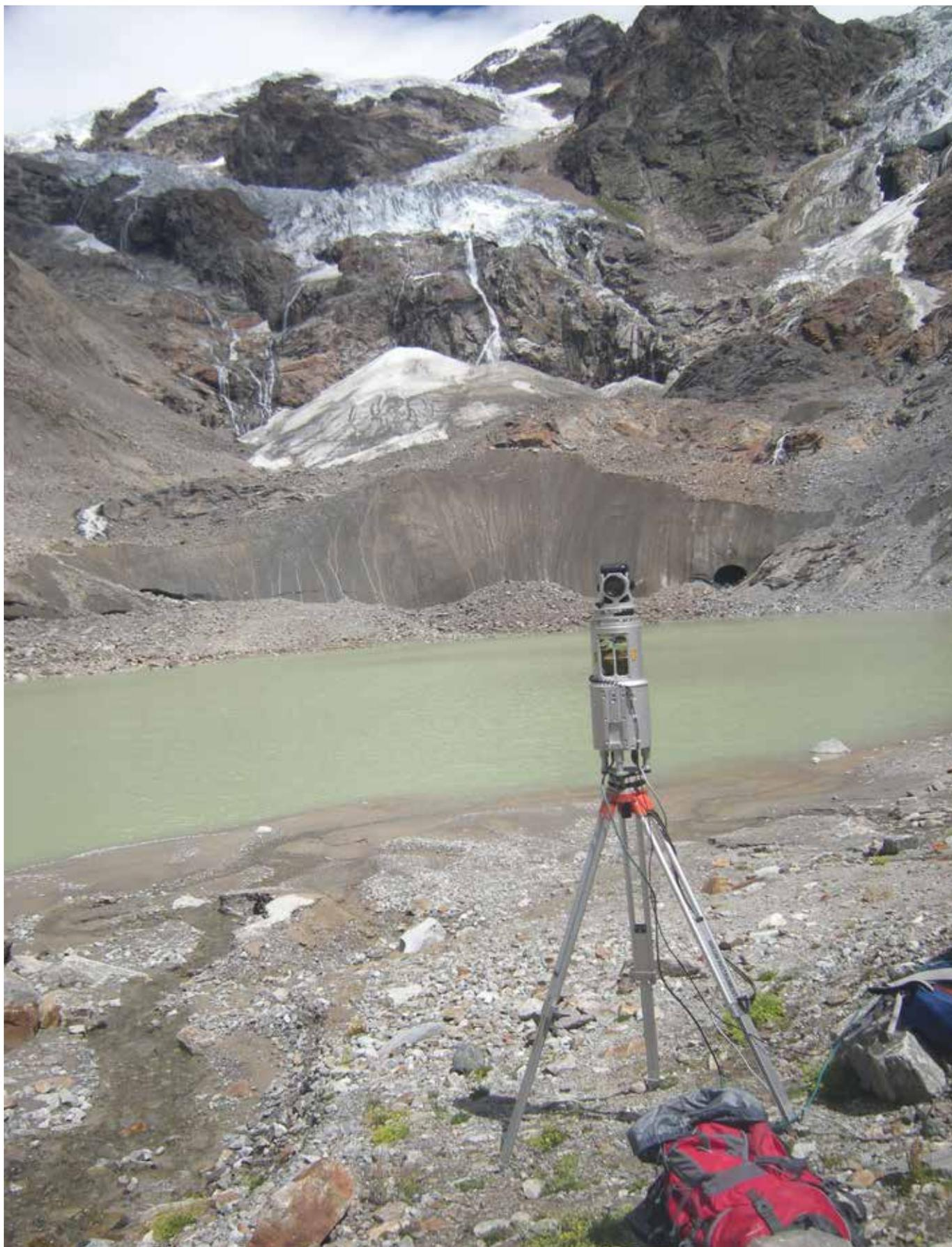
*LYS: Rilievi laser scanner sul Ghiacciaio del Lys. Lo strumento permette di ottenere un modello tridimensionale ad alta definizione della lingua del ghiacciaio e del lago proglaciale. Ripetendo le misure e sovrapponendo i due modelli, è possibile quantificare le variazioni del ghiacciaio non solo areali ma anche volumetriche, variazioni che possono poi essere confrontate con i dati derivanti dalle analisi remote sensing (ph. C. Smiraglia)*
